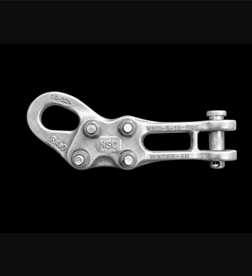
Grapa de remate recta aluminio para cable ACSR calibre #6-3/0
