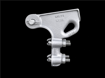
Grapa tipo pistola aluminio para cable ACSR calibre #2-336
