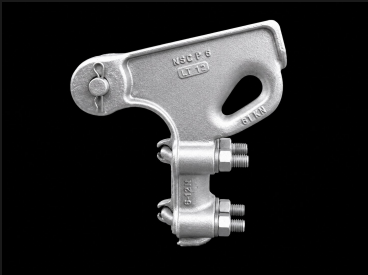
Grapa tipo pistola aluminio para cable ACSR calibre #4/0-477
